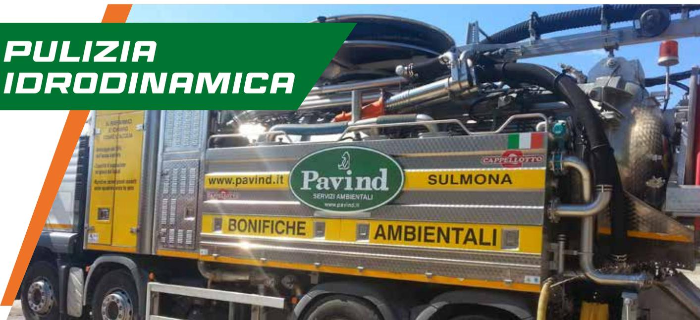
Automezzo con tecnologia in grado di combinare aspirazione e pulizia idrodinamica con riciclo continuo dell'acqua, dotato del sistema esclusivo integrato Recycling System che separa l'acqua dai fanghi a mezzo di speciali filtri e separatori consentendo un riutilizzo continuo ed immediato con la pompa a pressione.
